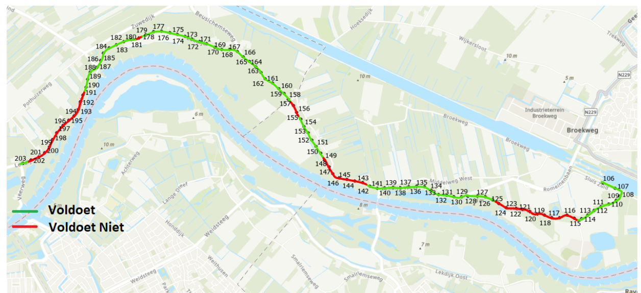
Figuur 9-2: Oordeel Piping (STPH) fase NKO.
