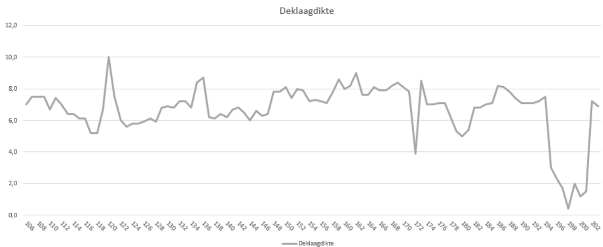
Figuur 4-10: Deklaagdiktes [m] langs het deeltraject ICU
